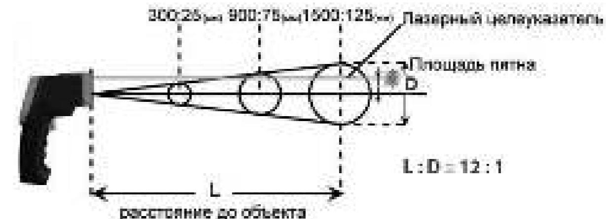
Диаметр пятна D должен соответствовать размеру объекта (диаметр, ширина), температура которого измеряется этим ИК термометром на расстоянии L.
