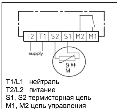
Рис 17: Подключение модуля защиты
